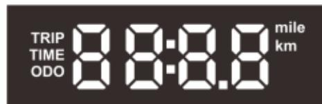
总里程 ODO、单次里程 TRIP、实时电压 V、运行电流 A、运行时间 TIME、故障代码 E、检测代码UE
